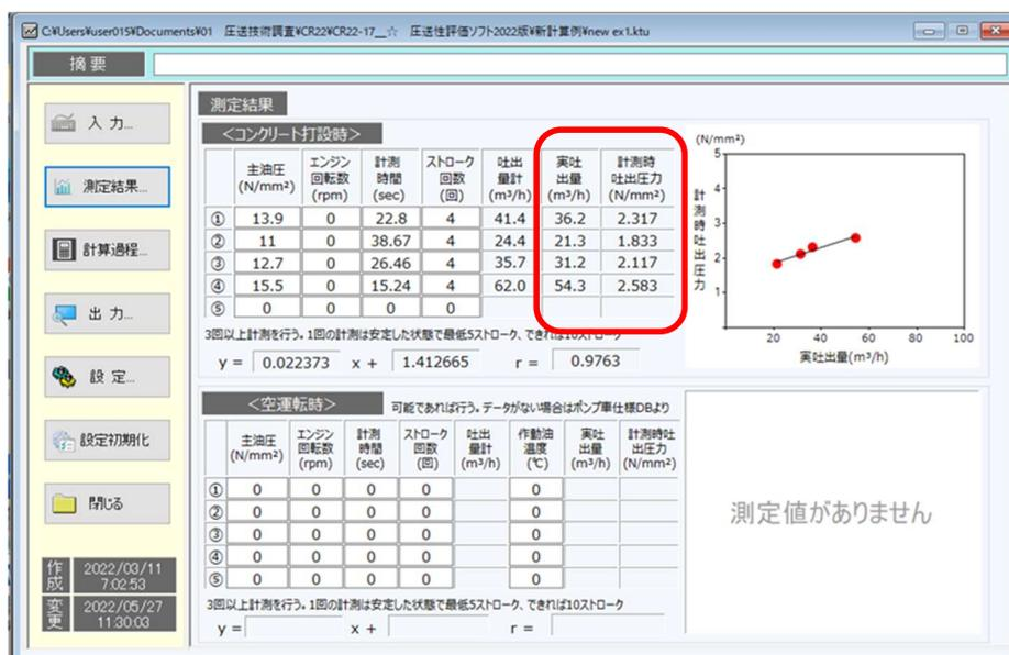
従来、実吐出量と計測時吐出圧力のグラフ表示の元データが表示されておりませんでした。グラフ各点のデータを数値表示させるように変更いたしました。
